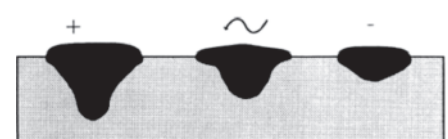
Figur 5.46. Inntrengningsdybden ved DCEN, DCEP og vekselstrøm.
