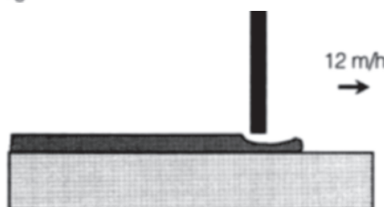
Figur 5.43. Sveisehastighetens innflytelse på smeltebåndet.
